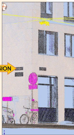
Рис. 2b Облака точек после применения RiPRECISION
