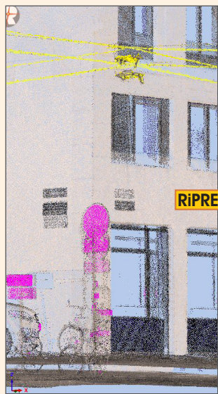
Рис. 2a Облака точек двух проездов
